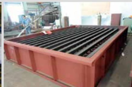
通过工厂检验测试后整体喷吹单元
