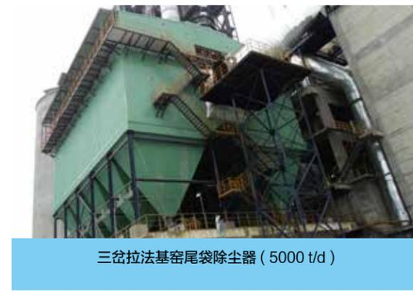
三岔拉法基窑尾袋除尘器 (5000 t/d)
