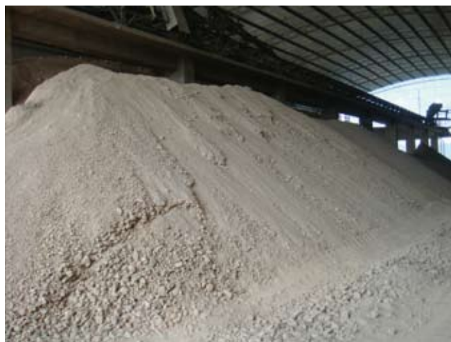
生产硫铝酸盐使用的铝矾土（原料） Bauxite (raw material of sulphoaluminate cement)
