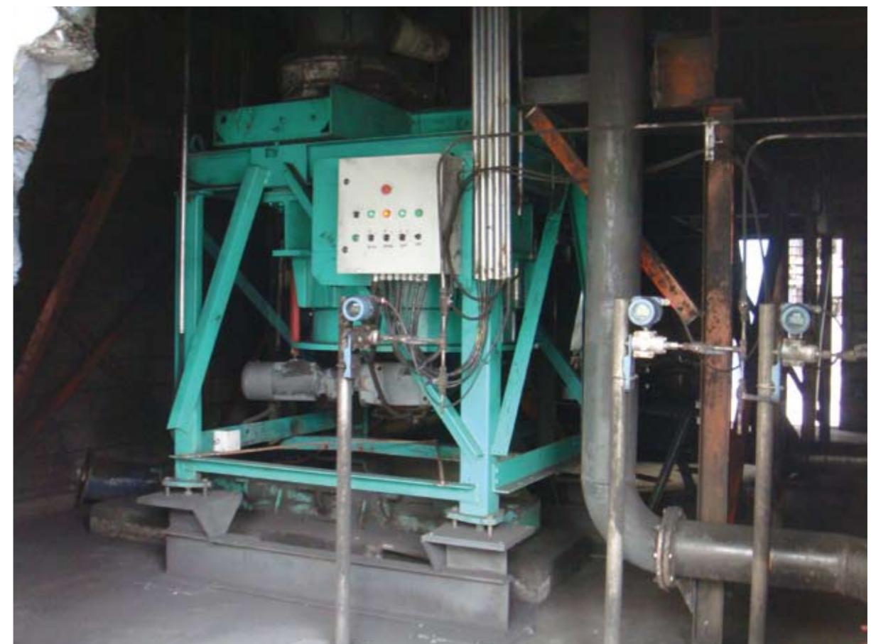
图4 北水3000t/d生产线技改用煤粉计量与控制系统外形图
